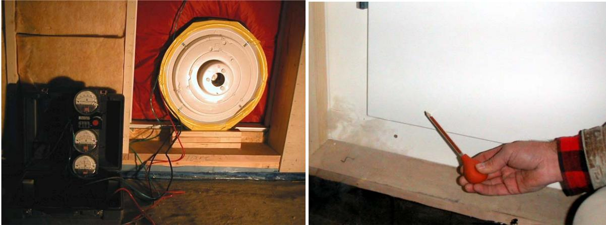
Abbildungen 4 und 5: Messanordnung Blower Door und Rauchrohrtest
