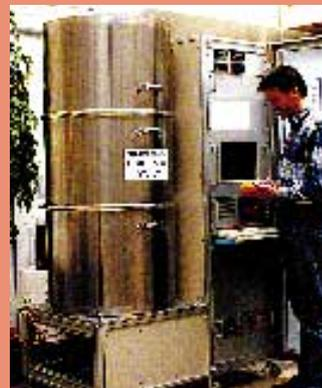
Ein 7-kW-HEXIS-System: im Gehäuse links Zellenstapel und alle Nebengeräte, rechts die elektronische Steuerung.
