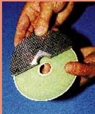
Bestandteile einer HEXIS-Zelle: keramische Membran (grün) mit Elektroden, Kanal-Platte für Brennstoffzufuhr und Verbrennungsprodukt-Ableitung.
