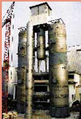
Die thermohydraulische Testanlage PANDA am PSI dient zum Funktionsnachweis passiver Sicherheitssysteme.
