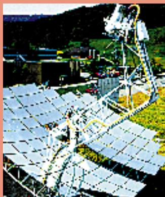
Im Brennpunkt des 90-m<sup>2</sup>-Parabolspiegels am PSI steht ein Zyklon-Solarreaktor, der mit 56 kW konzentrierter Sonnenstrahlung beheizt wird.
