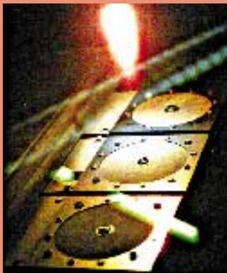
Mehrere HEXIS-Membranen von je 12 cm Durchmesser werden hier durch Plasmasprühen im Vakuum gleichzeitig hergestellt.
