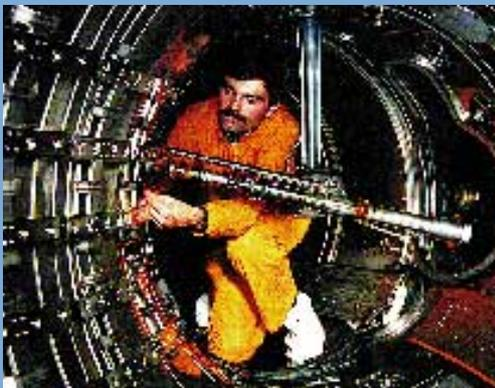
Internationale Zusammenarbeit zur **Kernfusion**: In der Schweiz entwickelte Beschichtungen des Tokamak-Innenraums mit Borkarbid im Bild im JET – halten das Plasma weitgehend frei von Verunreinigungen.
