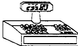
Die Kasse wurde als einständiges Gerät entwickelt. Auf der Hauptplatine sind alle Möglichkeiten der Kassen bereits berücksichtigt (Anzeigen, Netzwerkfunktionen, Handscanner usw.). Diese Kassen arbeiten aus Sicherheitsüberlegungen und wegen der resultierenden einfacheren Programmierung meist mit herstellereigenen Betriebssystemen. Man nennt diese Kassen, weil sie üblicherweise auf eine Harddisc verzichten, RAM-ROM-Maschinen.
