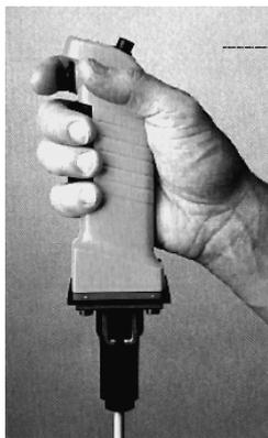
Bild 3) Dreistufiger Zustimmungsschalter für sicheres Arbeiten im Sonderbetrieb (Mattle Industrieprodukte, Hinwil).
