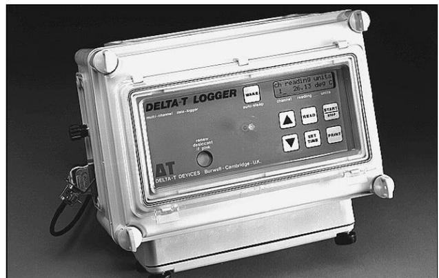
Bild 79: Datalogger (Quelle: Flexum Messtechnik AG, 8636 Wald)
