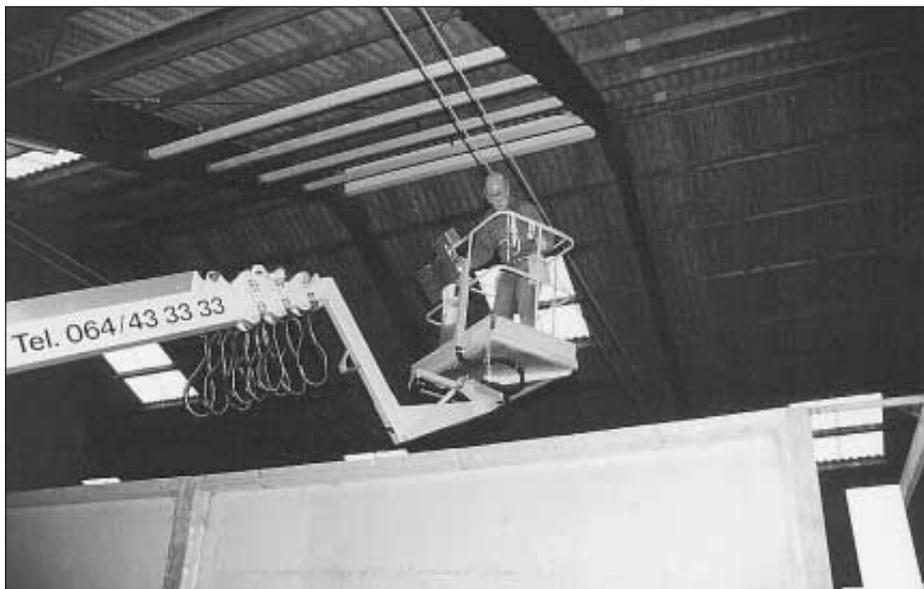
Aufgrund von theoretischen Angaben kann ein geeignetes Gerät nur rudimentär bestimmt werden. Beim Einsatz im Gebäude erhalten andere Masse, z. B. Schwenkbereich oder hinterer Überhang, mehr Bedeutung. Diese Angaben sind nur schlecht aus Prospekten zu entnehmen. Es empfiehlt sich, rechtzeitig eine Begehung mit dem Vermieter zu vereinbaren.
