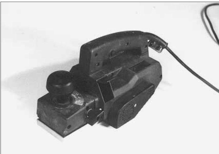
**Handhobelmaschinen** dagegen können als praktische Helfer für Ein- und Anpassarbeiten eingesetzt werden.
