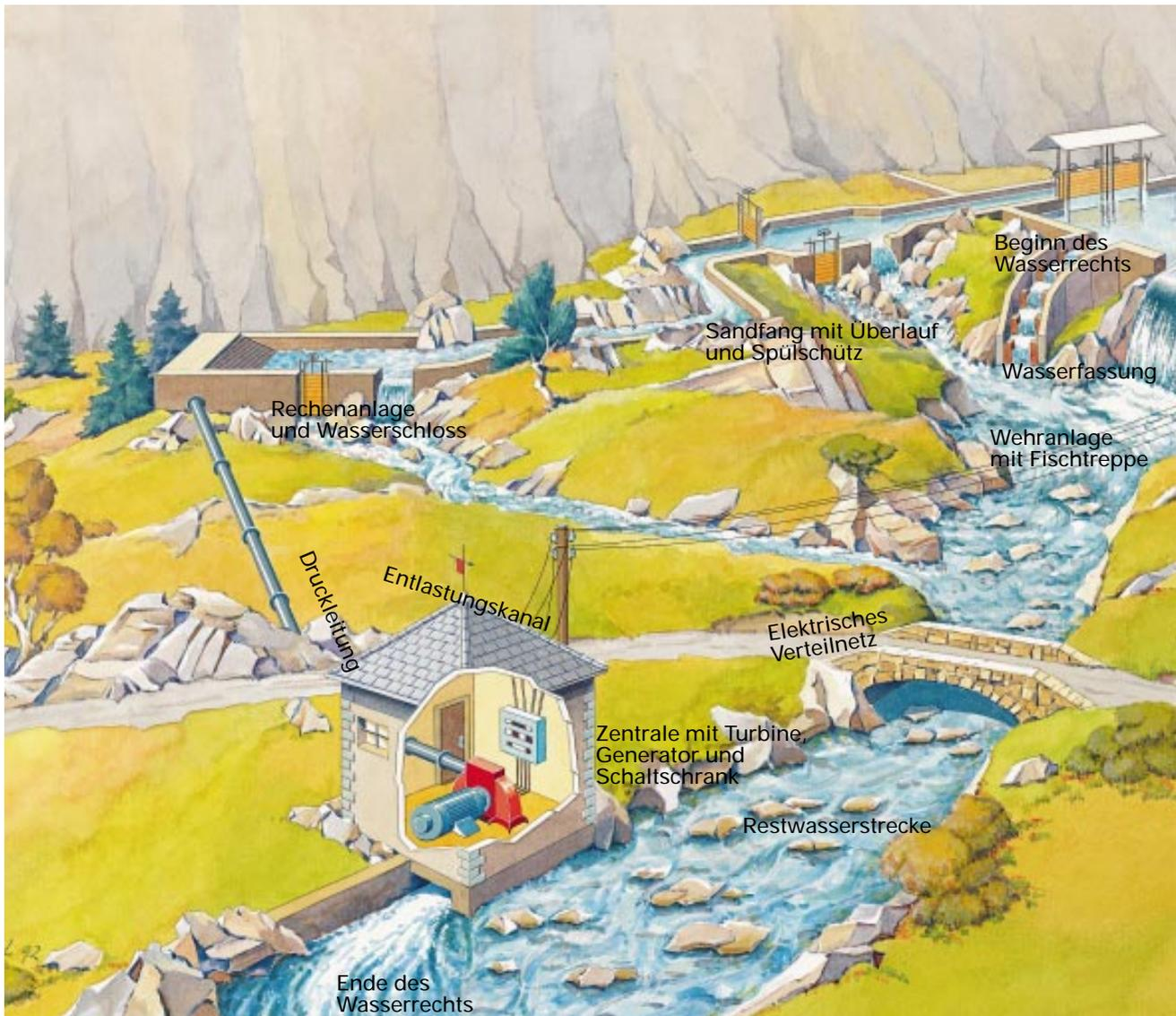
Abbildung 2.1: Allgemeine Anordnung eines Hochdruckkraftwerkes im Seitenkanal
