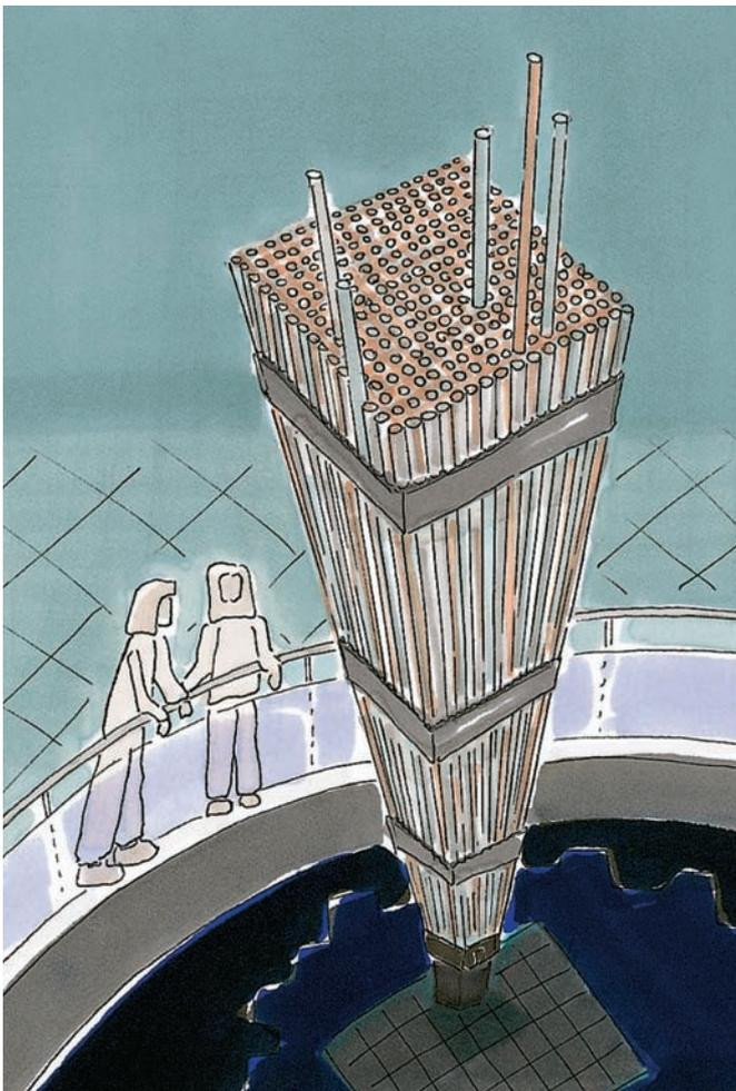
Diese werden hintereinander in Brennstäbe gefüllt und zu Brennelementen zusammengenommen. Diese Brennelemente werden in der Tiefe des Reaktorkerns versenkt, der ist mit Wasser gefüllt und mit Stahlbetonschichten geschützt. Uran besteht aus Milliarden von winzigen Teilchen, den Atomen. Jedes Atom besitzt einen Kern. Wenn man diese Atomkerne spaltet, entsteht Kernenergie. Bei der Spaltung wird Wärme freigesetzt, die zur Erzeugung von Elektrizität genutzt wird. (Siehe Stromerzeugung Seite 16)
