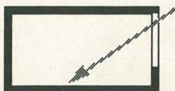
Hat das Fenster keinen Sturz, dringt das Tageslicht tiefer in den Raum ein. Der Anteil des Zenithimmelslichtes erhöht sich, wodurch der Raum heller wird.
