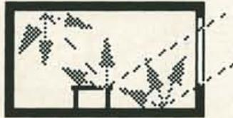
Tageslicht fällt durch ein Fenster ein und wird von den Oberflächen, auf die es auftritt, reflektiert. Helle Oberflächen haben einen höheren Reflexionsgrad als dunkle, leiten also mehr Licht weiter. Sind die Anstriche und Materialien von Decken, Wänden, Böden und Möbeln hell, wird das einfallende Licht besser weitergeleitet und die Helligkeit im Raum nimmt zu. Ein breiter und heller Sims unter dem Fenster (oder Oberlicht) kann viel zur besseren Belichtung eines Raumes beitragen.
