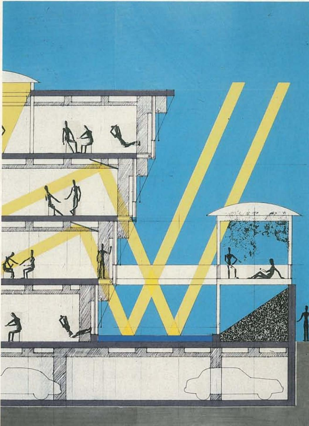
Durch Vorkragung jedes Geschosses über dem darunterliegenden gewinnt man Bodenlichtbänder, über die lebendiges Licht vom Spiegelbassin auf die Decke und dort über Spiegel in die hinteren Raumzonen projiziert wird. Kleine Wellen – hervorgerufen durch Wind, fallende Blätter oder leuchtende Wasservögel – bewirken Lichtspiele an der Decke.
