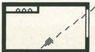
Hohe Räume sind für die Belichtung von Vorteil, da bei einem entsprechend hohen Fenster das Tageslicht auch die Tiefe eines Raumes erreicht. Ist eine abgehängte Decke unumgänglich, sollte sie nur im hinteren Teil eines Raumes angebracht werden. Zumindest ist der Bereich in Fensternähe freizulassen.
