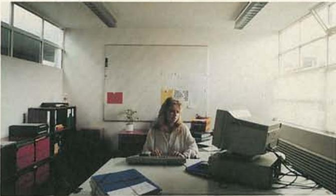
Die Arbeitsräume werden von zwei Seiten belichtet. Der helle Gang dient als zusätzliche Lichtquelle. Dank einem hochliegenden Fensterband und einer geschickt eingesetzten Schrägverglasung fällt Tageslicht auch in die hinteren Bereiche der Räume.
