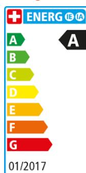
Gute Wasserspareinsätze und Duschbrausen sind mit der Energieetikette gekennzeichnet. Je weniger Wasser eine Duschbrause liefert, desto weniger Energie wird verbraucht. Geringe Durchflussmengen sind somit ein Indikator für eine hohe Energieeffizienz. Handbrausen zum Duschen der Effizienzklasse A (< 6 Liter/Minute) haben eine sehr geringe Durchflussmenge und eignen sich hauptsächlich im privaten Umfeld.
