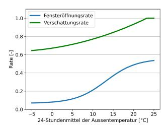
Hauptergebnis der VenTSol-Studie: Mit zunehmender Aussentemperatur steigt der Anteil der geöffneten Fenster ebenso wie der Anteil der verschatteten Fenster. Grafik: Schlussbricht VenTSol
