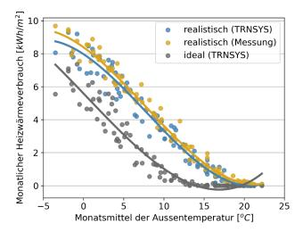
Heizwärmeverbrauch in Abhängigkeit von der Aussentemperatur für 40 Mehrfamilienhäuser: Die realitätsnahen Werte (blau und gelb) liegen deutlich höher als die Werte, die der Berechnung des Energienachweises zugrunde gelegt werden (grau). Grafik: Schlussbericht VenTSol
