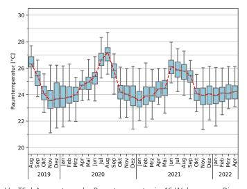
VenTSol-Auswertung der Raumtemperatur in 46 Wohnungen: Die Temperaturen liegen deutlich über den 20 °C, die die SIA-Norm den geltenden Berechnungen zugrunde legt. Grafik: Schlussbericht VenTSol
