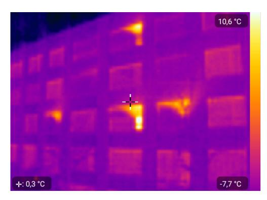
Fassadenausnahme mit einer Wärmebildkamera: Helle Flächen zeigen offene Fenster. Der Eintrag kühler Luft bei geöffneten (Kipp-) Fenstern fällt bei gut gedämmten Gebäuden relativ stark ins Gewicht. Foto: VenTSol
