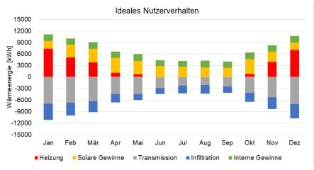
Vergleich des Heizwärmeverbrauchs gemäss SIA-Norm (Abbildung oben) und in der Realität (Abbildung unten). In der Realität ist der Heizwärmebedarf deutlich grösser, und die solaren Gewinne sind deutlich kleiner. Das Nutzerverhalten fällt bei neuen Gebäuden mehr ins Gewicht, weil diese viel besser wärmegedämmt sind als ältere Gebäude. Grafik: Schlussbericht VenT-Sol
