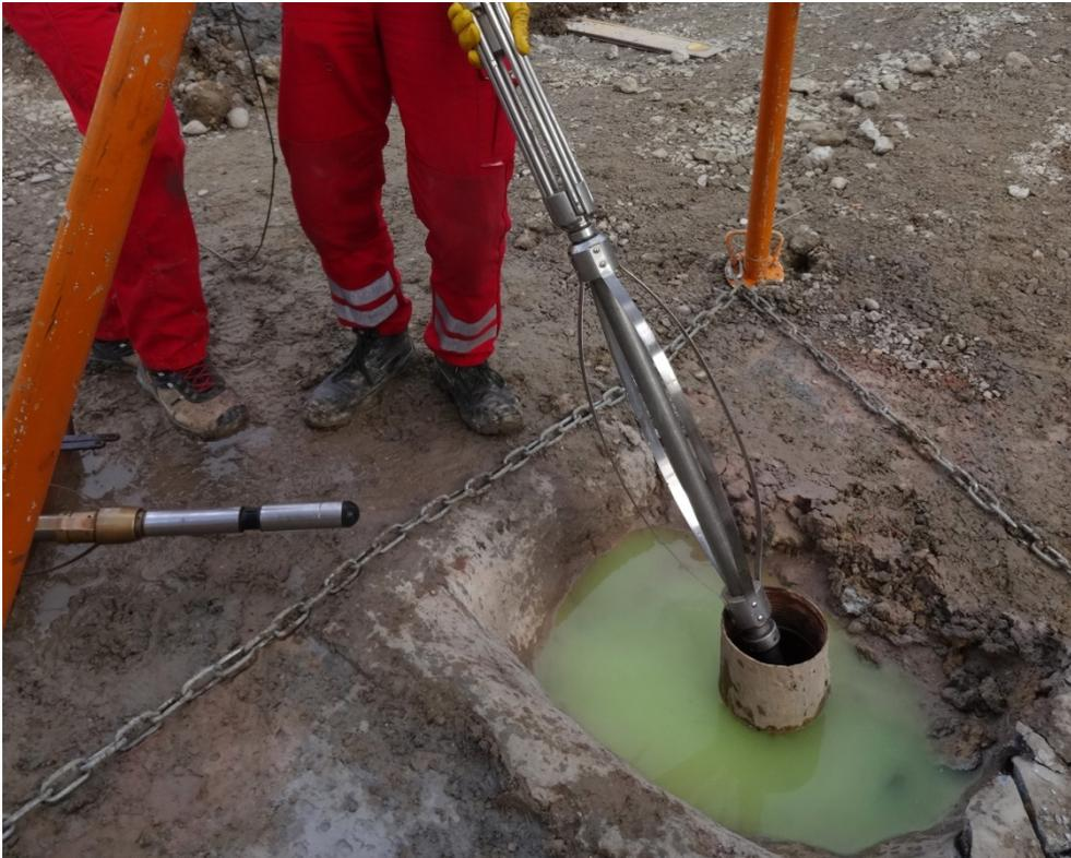
**Abb. 10 Logging in Kernbohrung**
