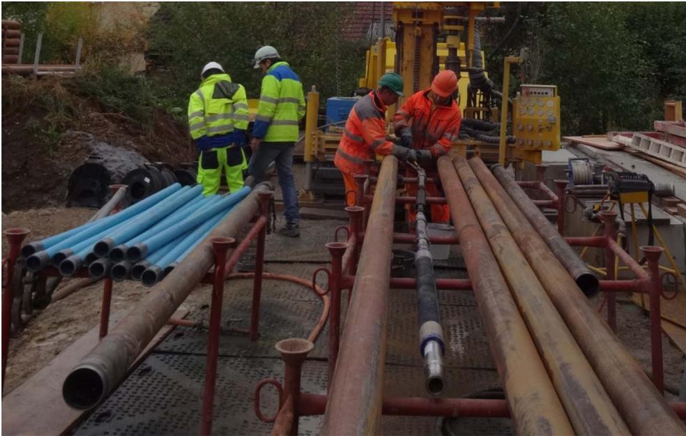
**Abb. 11 Packertests in Kernbohrung Lausen**
