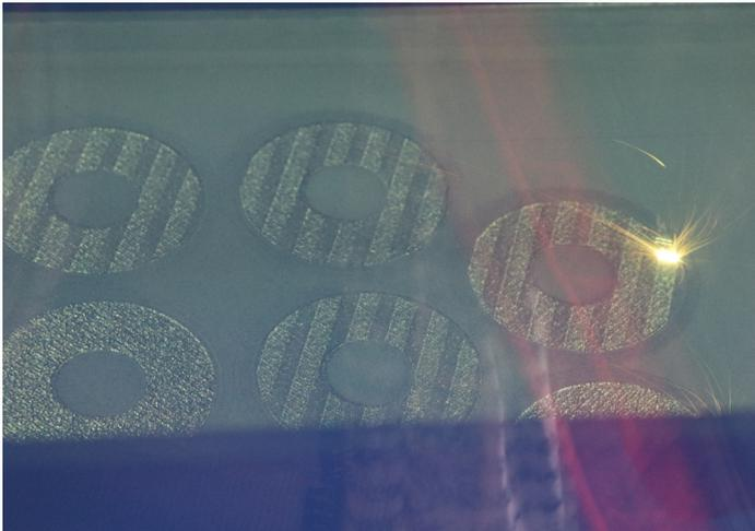
Blick durch das Sichtfenster ins Innere eines AM-Geräts: Zu sehen ist einer der beiden Laser, während dieser eine hauchdünne Schicht aus Metallpulver aufschmilzt und so zu einer Metallschicht verbindet. Jeder Laser ist ein stark gebündelter Lichtstrahl mit 400 Watt Leistung. Der AM-Prozess findet unter Stickstoff statt, um die Bildung von Schmauch (Rauch) und Spritzern zu vermindern. Foto: B. Vogel
