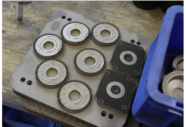
Blick auf Spritzguss-Werkzeuge, die im Pulverbett additiv gefertigt wurden (vgl. Bild links). Bei den runden Teilen sind die Kühlkanäle, die sich beim fertigen Teil im Inneren befinden, gut ersichtlich. Foto: B. Vogel
