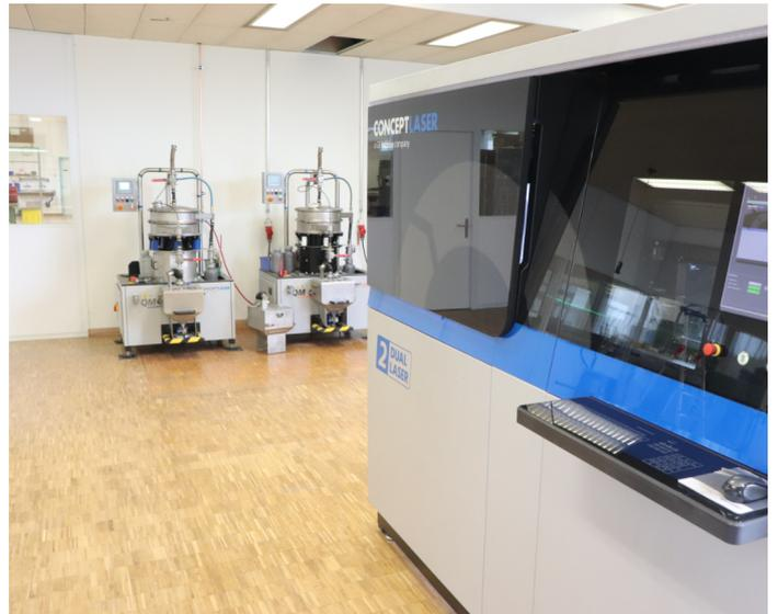
Die zwei Siebstationen im Hintergrund werden benötigt, um die Schmutzpartikel, welche bei der additiven Fertigung entstehen, aus dem Produktionspulver auszusieben. Auf dem Weg können rund 90 % des Metallpulvers wiederverwendet werden. Die übrigen 10 % werden als Altmetall entsorgt. Foto: B. Vogel
