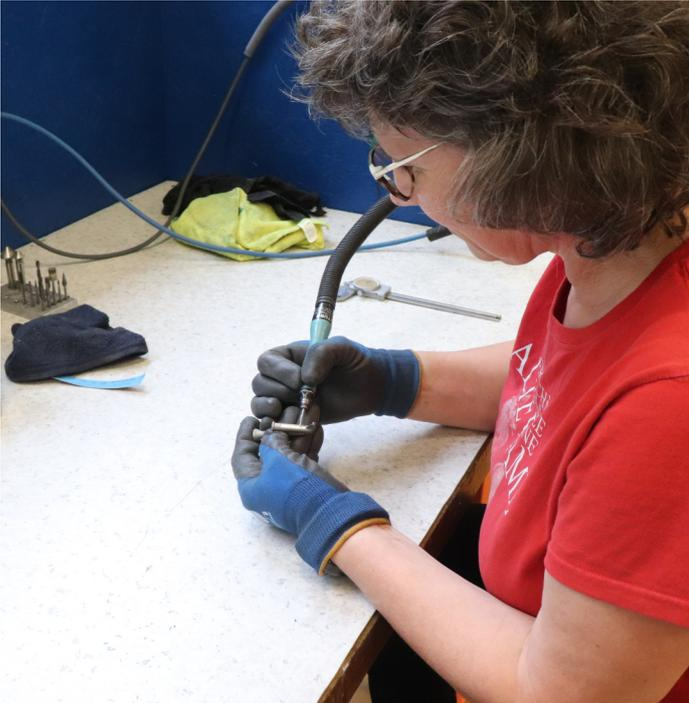
Ca. 80 % aller additiv gefertigten Metallteile müssen mechanisch nachbearbeitet werden, bevor sie an die Kundschaft ausgeliefert werden. Dafür werden Verfahren wie Fräsen (Bild), Drehen, Schleifen oder Sandstrahlen eingesetzt. Foto: B. Vogel
