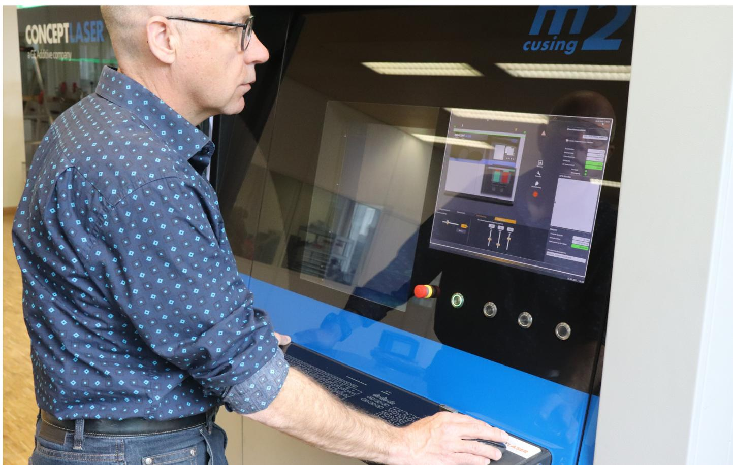
Feramic-Geschäftsführer Martin Hofer am Bedienungspult einer Anlage für additive Fertigung. Das Gerät stellt während eines 12- bis 48-stündigen Arbeitsgangs gleichzeitig mehrere Werkstücke her. Foto: B. Vogel
