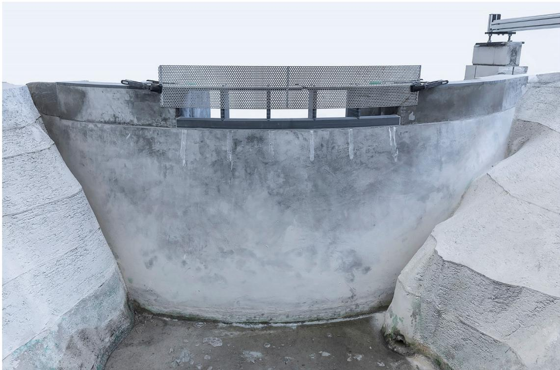
Abb. 3-7 Abstraktion des Verkläusungskörpers durch ein Lochblech mit Porosität  $n = 0.4$  bei der Pfeilerauskrägung  $p_K = 0.56$  m am Standardwehr VAW0902\_00087\_AS
