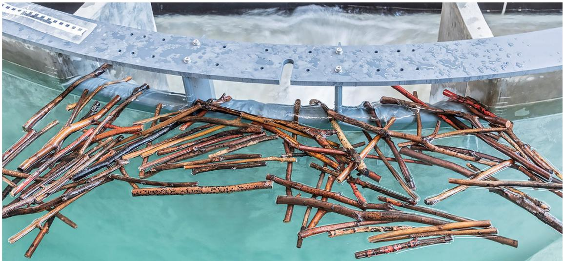
Abb. 5-8 Verklauungen auf der Wehrkrone für den Versuch mit relativer Stammlänge  $L_{50}/B = 0.73$ , Schwemmholzgruppe (c), breit verteilt und relative Überfallhöhe  $\chi = 0.5$ . Schwemmholz liegt auf der Wehrkrone auf. VAW0902\_00084
