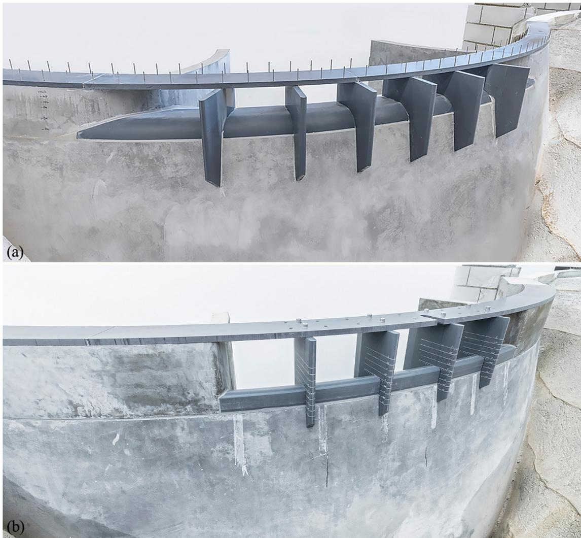
Abb. 3-6 *Detailansicht des Mauerüberfalls im Modell für a) Ova Spin mit sechs und b) Standardwehr mit vier ins Oberwasser auskragenden Pfeilern VAW4386\_00043\_AS / VAW0902\_00085*
