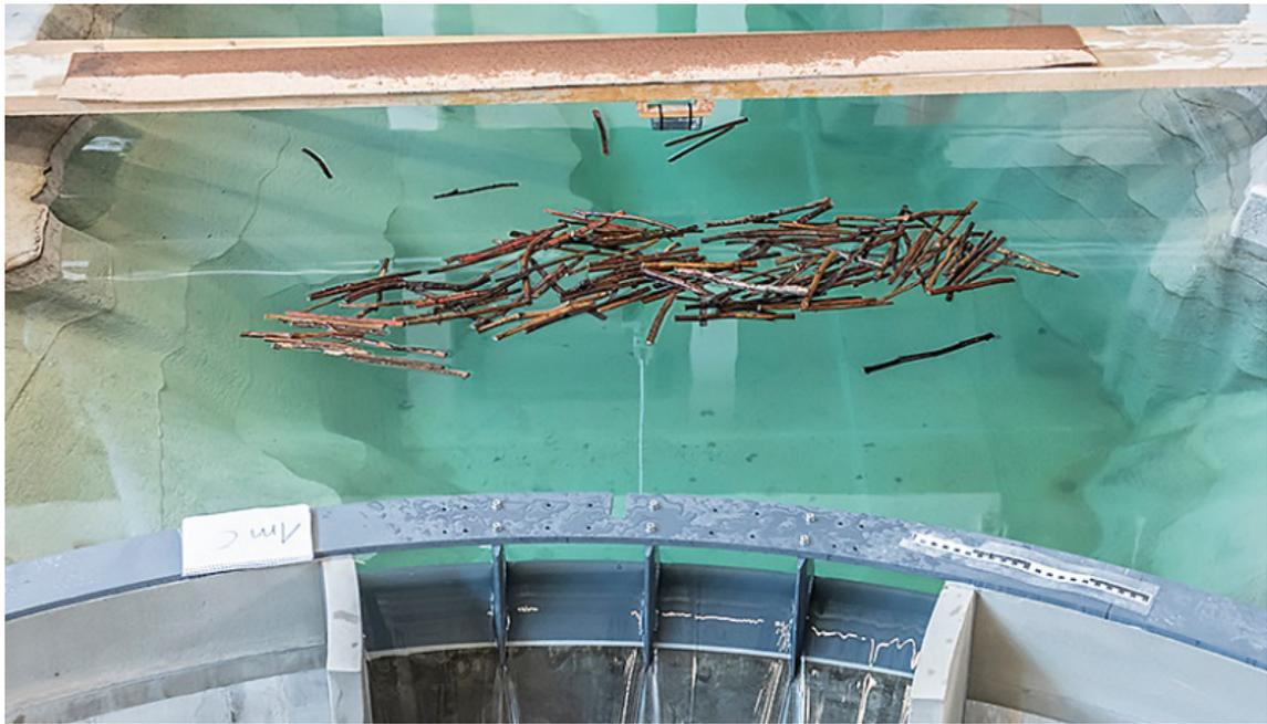
Abb. 5-4 Zugabe eines Schwemmholzteppichs am Beispiel eines Versuchs mit relativer Stammlänge  $L_{50}/B = 0.98$ , Schwemmholzgruppe (b), schmal verteilt und relative Überfallhöhe  $\chi = 0.5$ . Am oberen Bildrand liegt die verwendete Schwimmsperre auf dem Querbalken.
