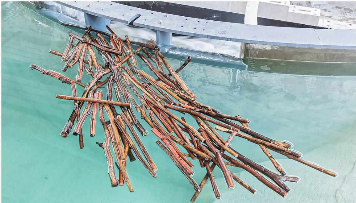
Abb. 5-9 Endverklauung des Versuchs mit relativer Stammlänge  $L_{50}/B = 0.73$ , Schwemmholzgruppe (c), breit verteilt und relative Überfallhöhe  $\chi = 1.0$ . VAW0902\_00082
