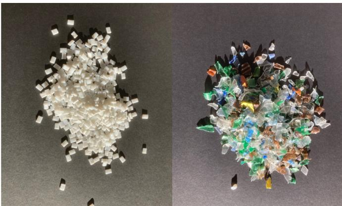
Kunststoffgranulat (links) ist das Ausgangsmaterial für die Herstellung synthetischer Garne. Diese können auch aus recyceltem Kunststoff (rechts) hergestellt werden. Fotos: B. Vogel
