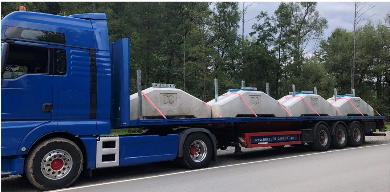
Abbildung 5: Transport der vorgefertigten Betonsockel mit einem LKW (© DC Carport Systeme)
