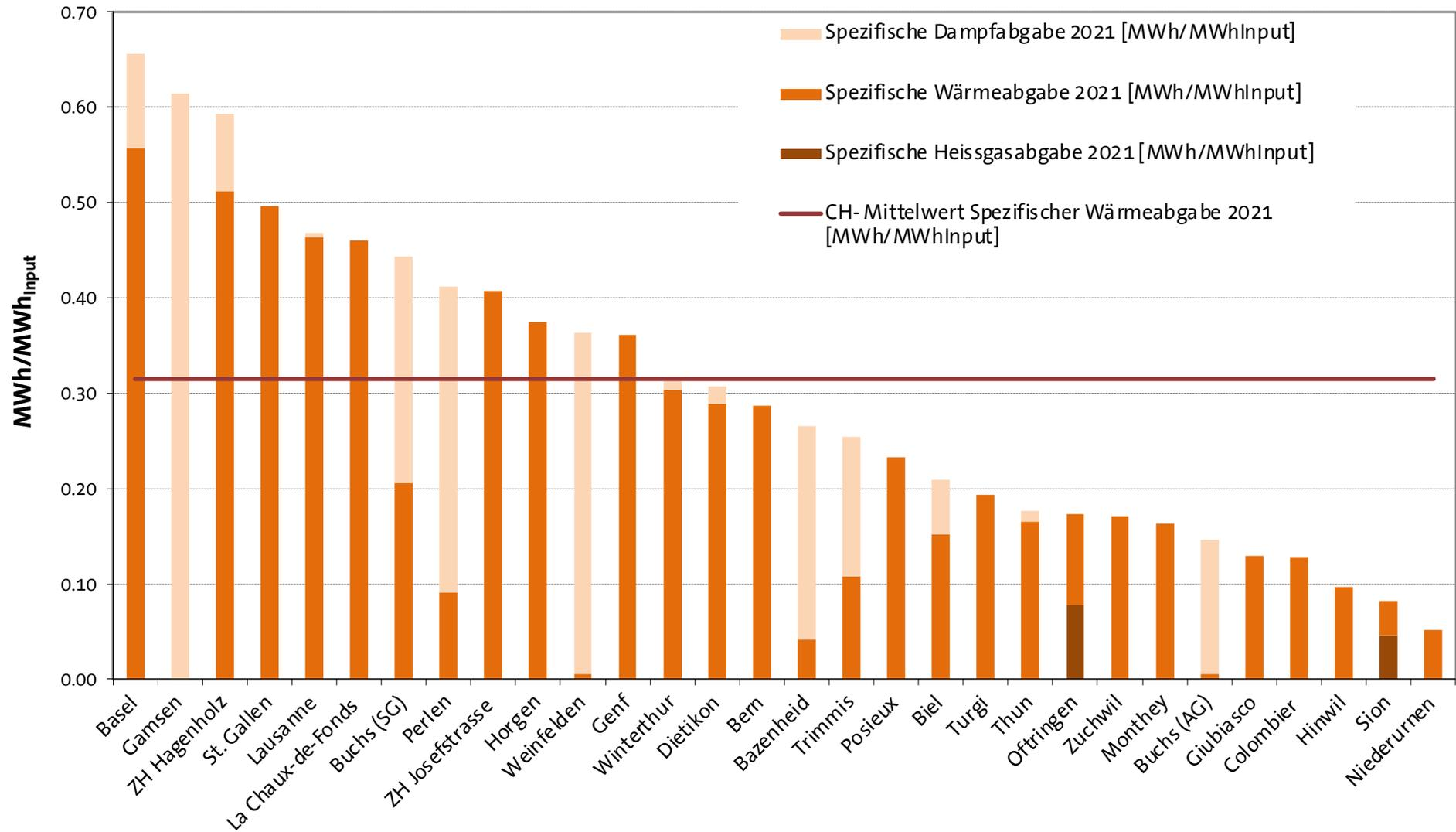
Abbildung 12: Spezifischer Wärmeexport pro Energieinput 2021
