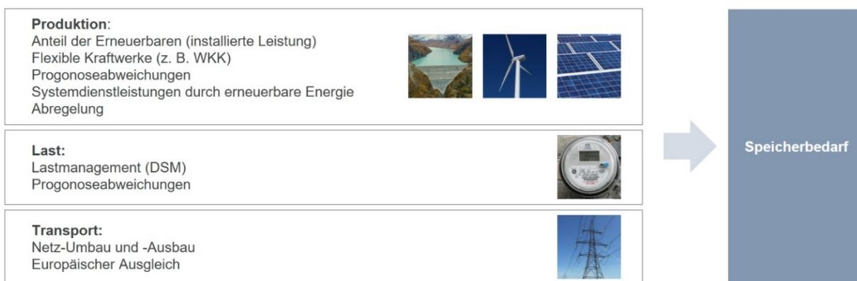
Abbildung 1: Energiespeicher bilden einen Baustein unter anderen zur Erhöhung des Flexibilitätsbedarfs in einem sich wandelnden Energiesystem. Speicher sind dort interessant, wo die Grenzkosten für alternative Flexibilitätsoptionen (etwa Netzausbau oder Abregelung von Spitzenproduktion) höher liegen als die Kosten für Speicher.
