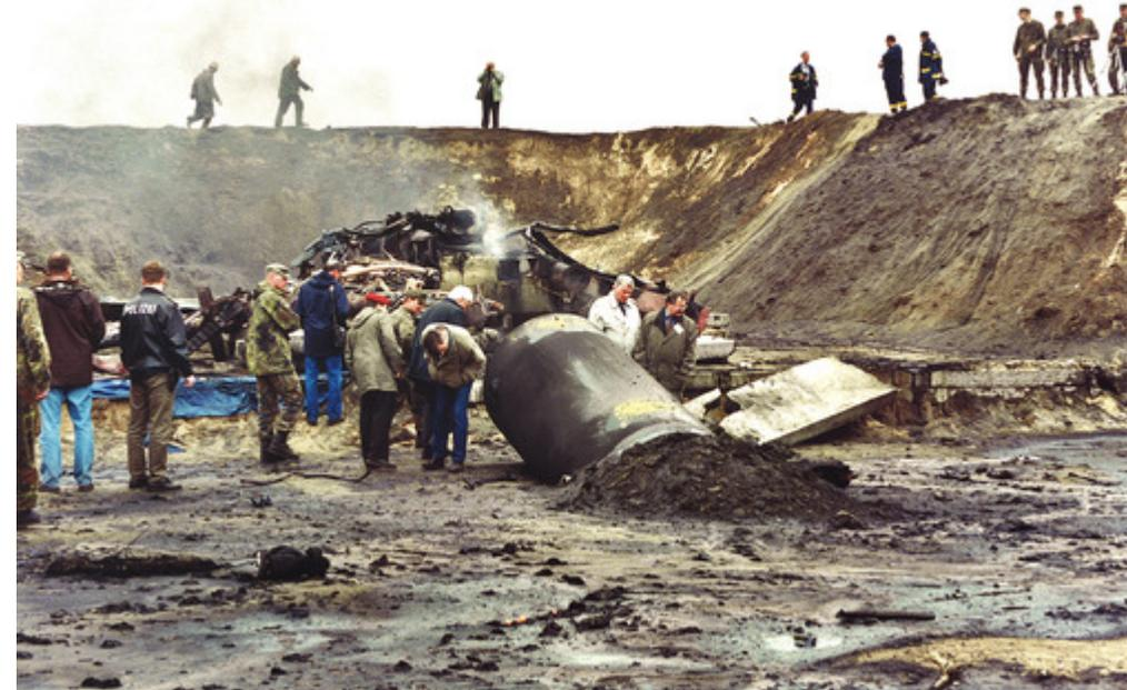
Unfallszenario experimentell simuliert: Explosion eines mit Propan gefüllten Kesselwagens. Der Feuerball des explodierenden Wagens war über 150 Meter hoch, Einzelteile des Propantanks flogen bis zu 200 Meter weit. Die Dichtungen des Behälters hielten der Explosion stand, obwohl der Versuch ohne die schützenden Stossdämpfer durchgeführt wurde. *Quelle: BAM*
