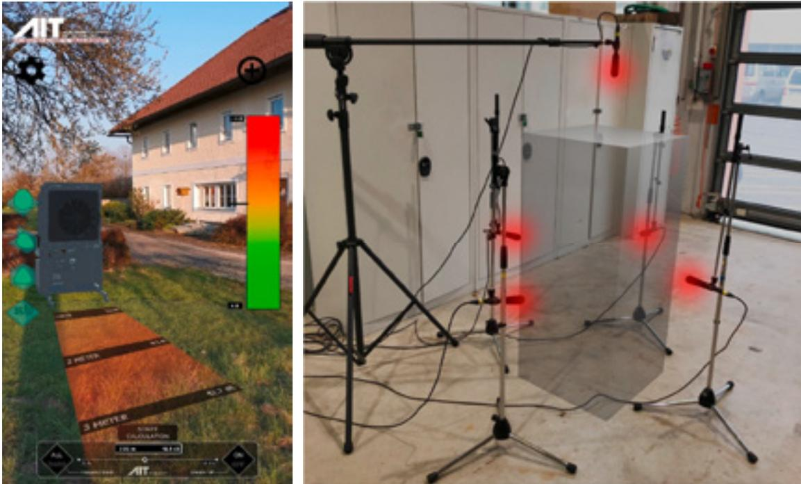
Bild 15: Der Laborwärmepumpenprototyp SilentAirHP wird virtuell in eine reale Welt eingeblendet und die Schallemissionen werden sichtbar gemacht (links); 5-Kanal Messsystem zur Generierung der Datenbasis für die Auralisation der Wärmepumpen in der Augmentend Reality App.
