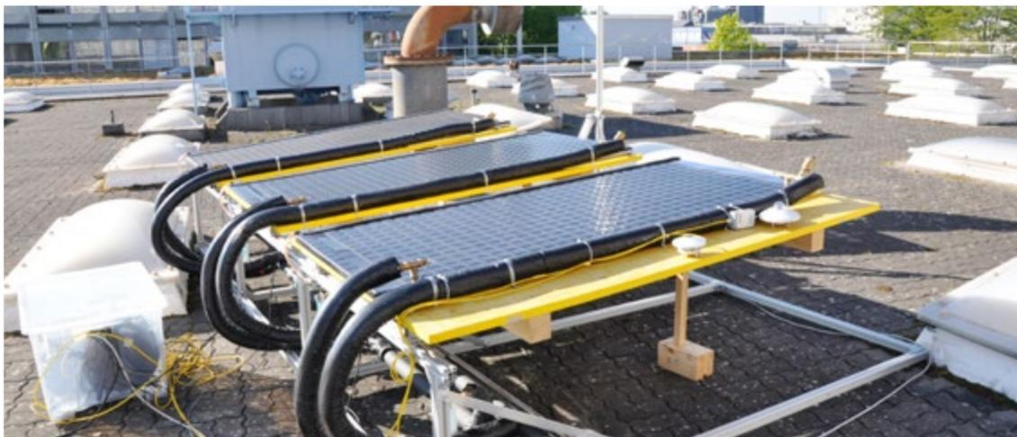
Prüfstandmessungen zur Kühlleistungsbestimmung von drei Solarabsorber im Rahmen des Projektes «Heizen und Kühlen über thermisch aktivierte Aussenflächen» an der FHNW. Die ungedeckten Solarabsorber funktionieren als Aussen-Wärmeübertrager und können im Heizbetrieb Wärme von der Umgebung und durch Absorption von Solarstrahlung aufnehmen und im Kühlbetrieb während der Nacht Wärme an die Umgebung abgeben. © FHNW IEBau
