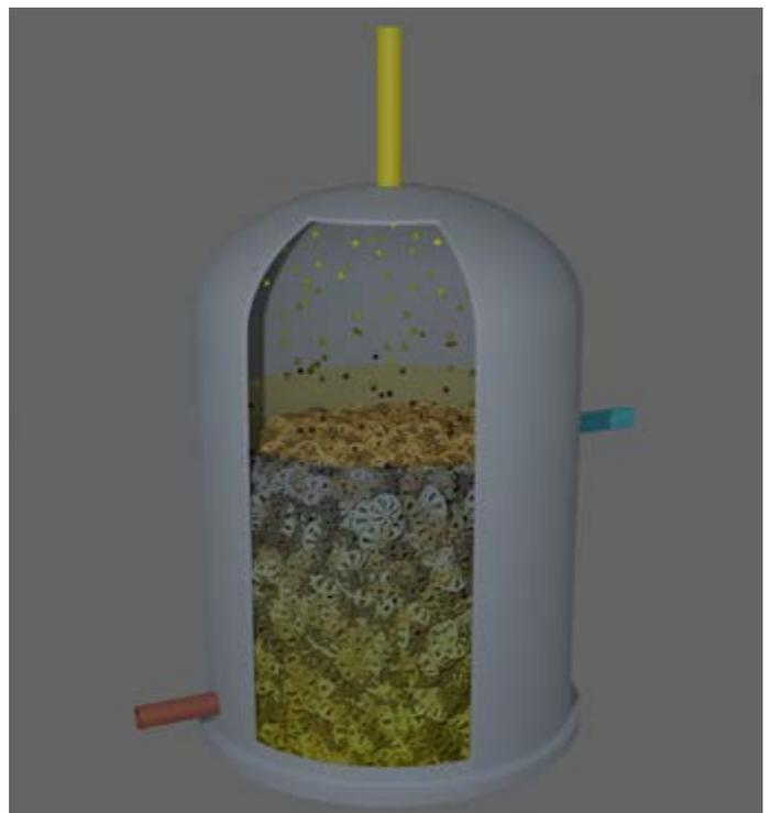
Abbildung 3: Anaerobfilter mit Plastikkörpern, welche die Mikroorganismen zurückhalten
